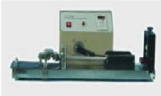
适用于印染纺织品耐干、湿摩擦及刷洗摩擦色牢度试验。将试样用干、湿摩擦布或毛刷摩擦后，用灰色样卡评定摩擦布或试样的沾色或变色情况，完全满足 GB / T 3920-2008《纺织品 色牢度试验 耐摩擦色牢度》，GB/T5712-1997《纺织品 色牢度试验 耐有机溶剂摩擦色牢度》，GB/T420-1990《纺织品耐刷洗色牢度试验方法》等标准。
