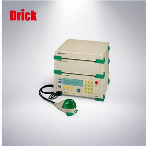
电穿孔是功能强大的将核酸、蛋白及其它分子导入多种细胞的高效技术。通过高强度的电场作用，瞬时提高细胞膜的通透性，从而吸收周围介质中的外源分子。这种技术可以将核苷酸、DNA 与 RNA、蛋白、糖类、染料及病毒颗粒等导入原核和真核细胞内。电转化相对其它物理和化学转化方法，是一种有价值 and 有效的替代方法。Gene PulserXcell 系统的设计，基于 Bio-Rad 15 年来在电转化技术上经验积累，它提供指数波和方波波型选择、系统配置选择及友好的用户界面。
