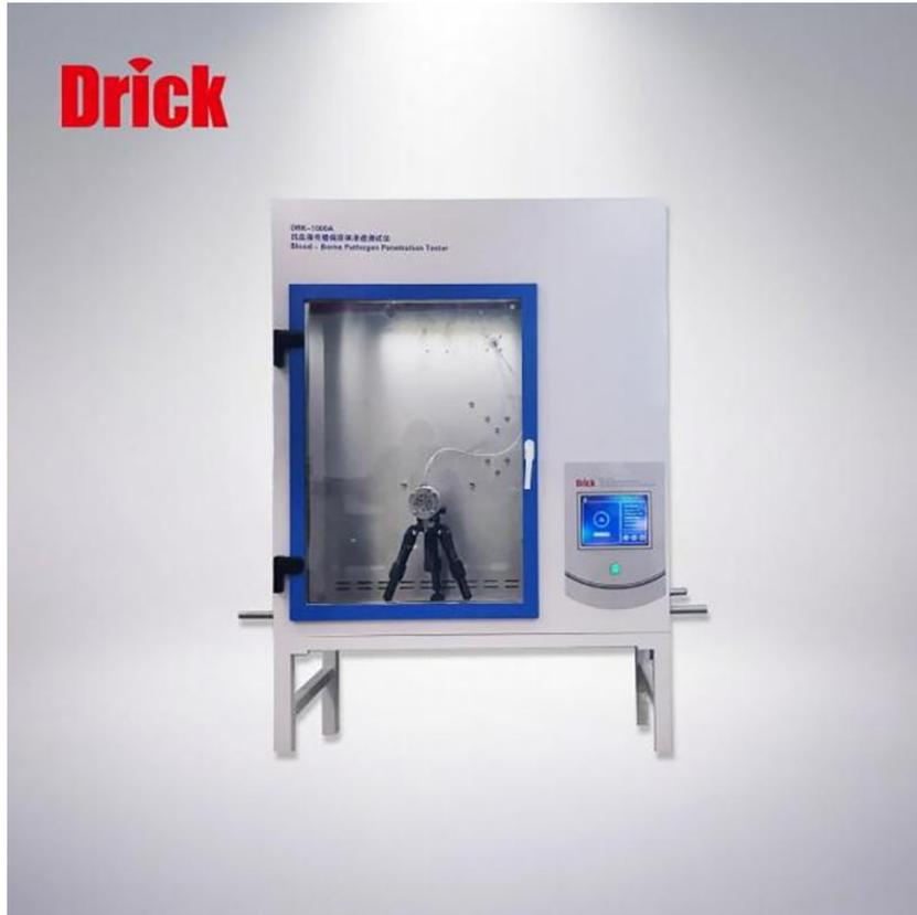
本仪器专为医疗防护服装耐血液等液体的渗透性测试设计；通过流体静力学压力测试方法对防护服材料抗病毒血液等液体穿透能力进行测试。用来测试防护服对血液和体液、对血液病原体（用 Phi-X 174 抗菌素测试）、对合成血等的抗渗透性。可以测试包括手套、防护装、外罩、连体工作服、靴子等防护装备抗液体渗透性能。
