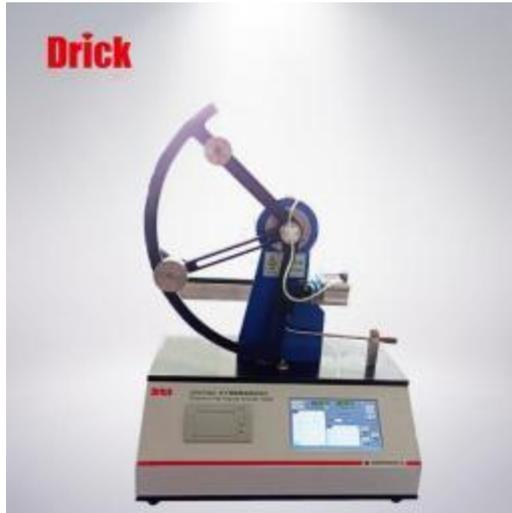
DRK108C 电子薄膜撕裂度测定仪适用于薄膜、薄片、软聚氯乙烯、聚偏二氯乙烯(PVDC)、防水卷材、编织材料、聚烯烃、聚酯、纸张、纸板、纺织品和无纺布等耐撕裂性检测。采用最新 ARM 嵌入式系统，大液晶触摸控制彩色显示屏，具有高精度、高分辨率的特点，模拟微机控制界面，操作简单方便，极大提高试验效率。性能稳定、功能齐全。
